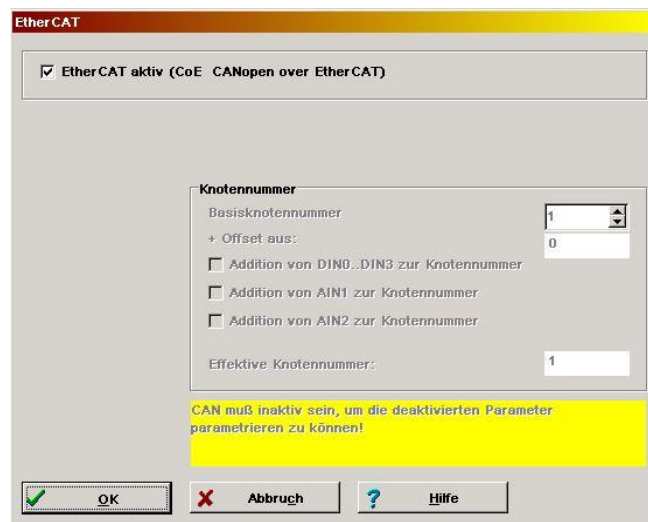
Abbildung 10: Einstellung der EtherCAT-Schnittstelle
