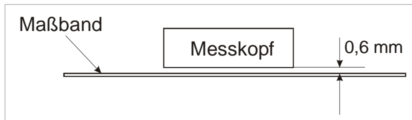
Abbildung 14: Abstand Maßband ↔ Messkopf
