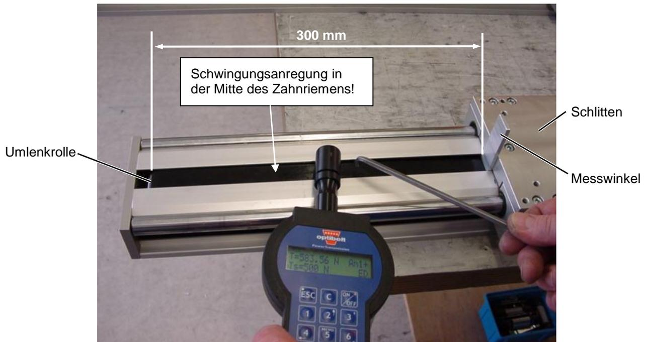
**Abbildung 2: Messung am Modul 105 durchführen**
