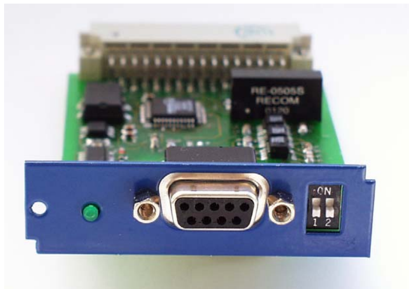
Abbildung 31: PROFIBUS-DP-Interface: Ansicht vorne
