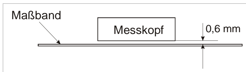
Abbildung 11: Abstand Maßband ↔ Messkopf
