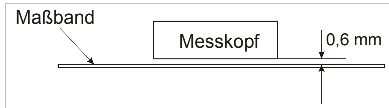
Abbildung 17: Abstand Maßband ↔ Messkopf
